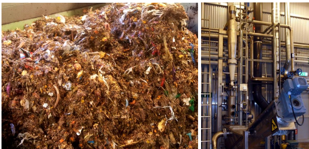
Foto 9: Vänster: Rejekt. Rejekthanteringen är inte helt intrimmat, varför rejektet förväntas bli torrare. Höger: Cyklon med utdragsskruv. Bilder: BioMil 2014
