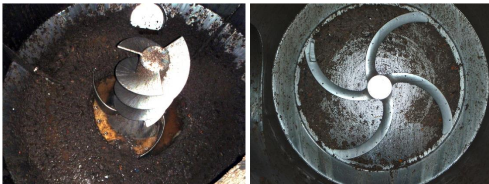
Foto 8: Pulper inifrån, nästan tom (vänster), rejektseparator GRS 3000 (höger). Bilder: BioMil 2014
