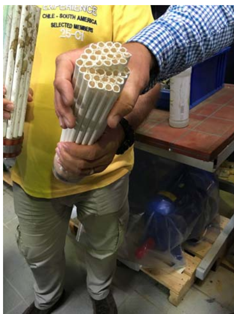
Figur 45. "Bunt" med ultrafiltreringsmembraner - hullfiber (foto ROAF)
