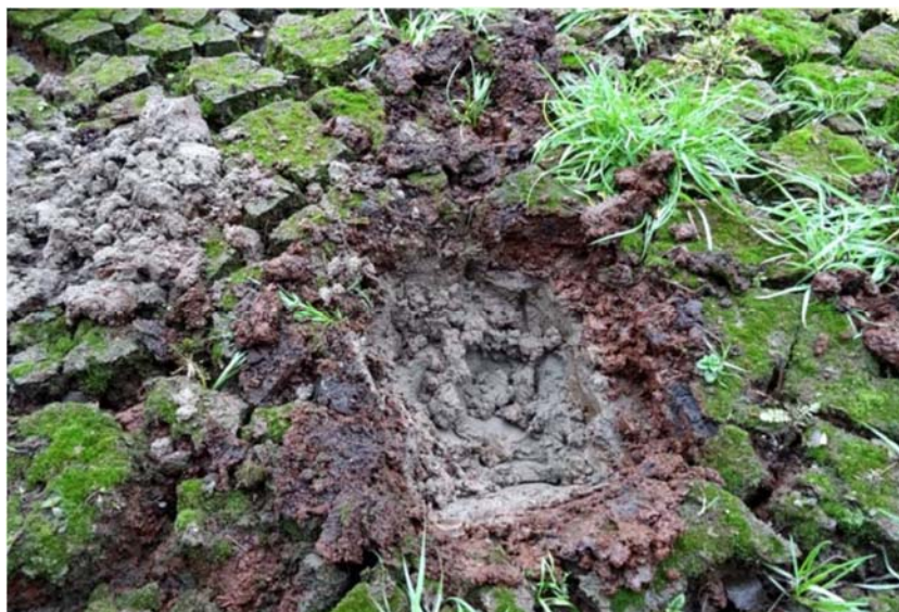
Figur 11. Eksempel på slamutfelling i infiltrasjonslagune (foto BB)
