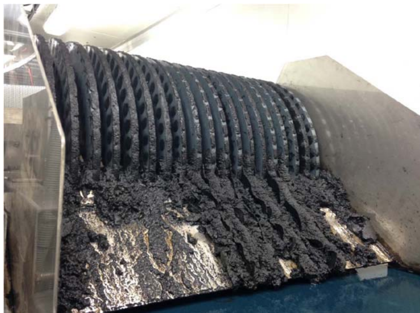
Figur 47. Magnetisk partikkelseparasjon - slamavvanning 1 (foto Hjeltnes Consult)
