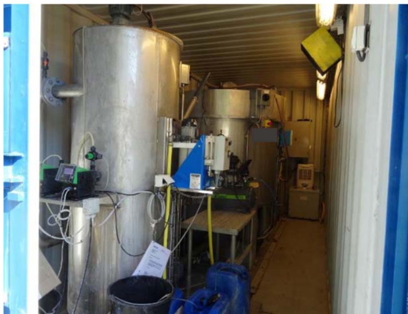
Figur 42. Container med flotasjonsanlegg
